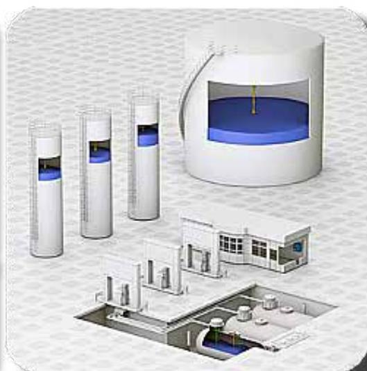
detectar presencia de agua. Para la medición de temperatura se utilizan 5 sensores alojados a lo largo del eje de la sonda, esto permite ajustar con precisión el volumen de producto que hay en el tanque. La temperatura de funcionamiento es de  $-40$  a  $71$  °C. Especialmente diseñada para trabajar en lugares peligrosos, Clase I División I.
